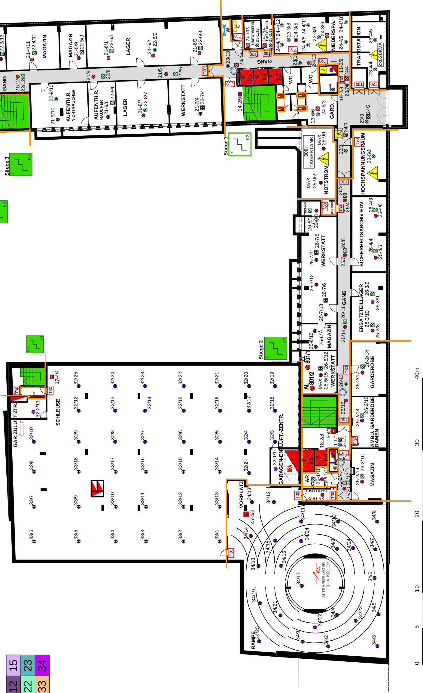
Beispiel Geschossplan-Brandschutzplan lt. TRVB 121 O
